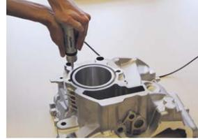
1. **Placez** la sonde sur l'échantillon à mesurer. La sonde doit être perpendiculaire à la surface ( $\pm 5^\circ$ ). Le pied spécial peut être utilisé pour augmenter la répétabilité et éviter la distorsion des résultats (voir chapitre «14. Informations sur la commande»).
