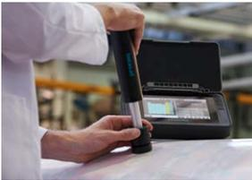
1. **Positionnez** la sonde sur la bobine à mesurer. Veillez à positionner la butée annulaire complètement sur la bobine pour garantir un impact perpendiculaire par rapport à la surface à mesurer.
