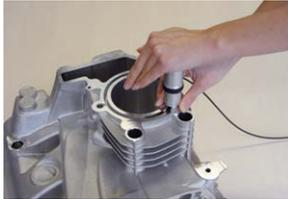
1. **Placez** la sonde sur l'échantillon à mesurer. Pour les surfaces planes, le pied standard convient parfaitement. Pour les objets cylindriques, il est recommandé d'utiliser l'un des pieds spéciaux. Pour les emplacements difficiles d'accès, un trépied peut être utilisé. Pour en savoir plus, reportez-vous au chapitre «14. Informations sur la commande».
