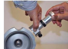
**Figure 18:** Portable Rockwell avec pieds spéciaux
