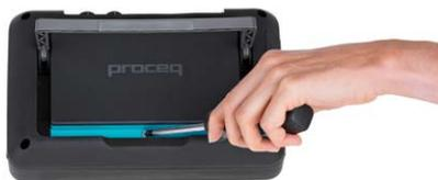
Figure 1: insertion de la batterie
