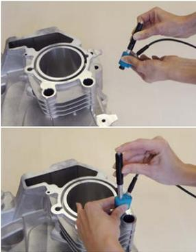
1. **Chargez** l'instrument de frappe, qui n'est pas en contact avec la pièce à mesurer, en le maintenant fermement d'une main et en faisant glisser le tube de chargement de l'autre main.
