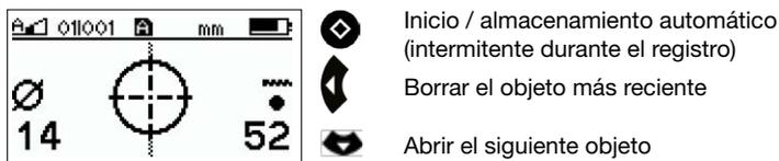
**Fig 37:** Visualización de almacenamiento automático
