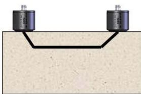
间接发射：信号振幅约为直接发射信号振幅的 3%。路径长度可能不确定。用表面速度模式消除这种不确定性。脉冲速度会受到混凝土表面区域的影响。如果可以，可比较间接发射和直接发射的测量结果，以消除不确定性。
