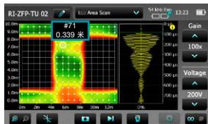
可将光标拖移到网格上的另一个位置以避开障碍物等。也可以将光标拖回之前的测量位置，并删除它或再次测量。在显示的示例中，显示了第 71 号测量，可删除或重新测量它。如果按下快照按钮重新进行测量，这之前的值会被覆盖。通过将光标拖移到待测量的下一个位置，黑色区域被排除在外。
