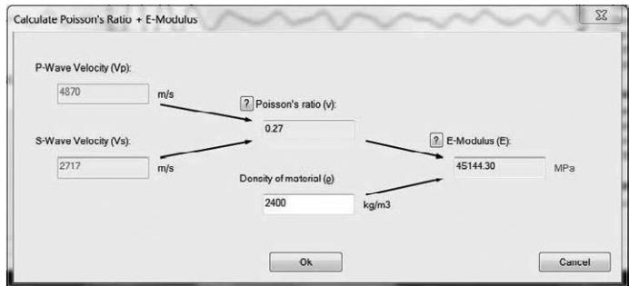
输入纵波和横波脉冲速度以计算泊松比。另外，输入材料的密度以计算弹性模量。
