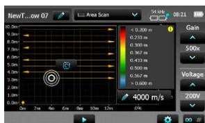
您可拖移光标以定位在想要开始测量的网格上。箭头指明继续测量的方向。
