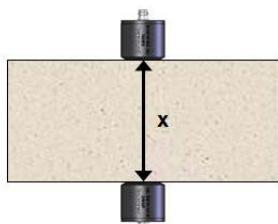
直接发射：最佳配置，信号振幅最大。脉冲测定最为精确。路径长度为各传感器中心之间的距离。
