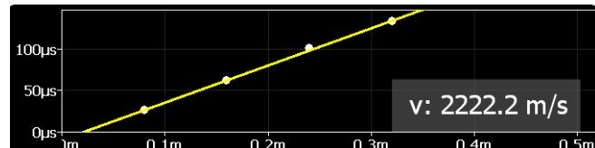
脉冲速度根据曲线斜率进行计算。
