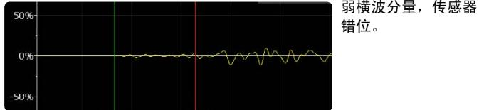
沿着对准方向旋入和旋出传感器，观察横波分量的增减情况。
