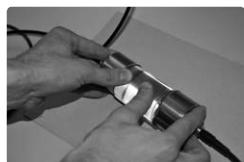
利用超声波耦合剂 (E) 耦合传感器和校准棒 (F)，然后紧紧按压在一起。
