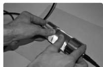
Schallköpfe unter Verwendung von Ultraschall-Koppelpaste (E) fest auf die beiden Enden des Kalibrierstabs (F) drücken.
