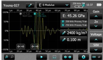
Der Doppelcursor-Modus ist automatisch aktiviert. Verwenden Sie den ersten Cursor, um den Beginn der P-Wellen-Komponente zu kennzeichnen.
