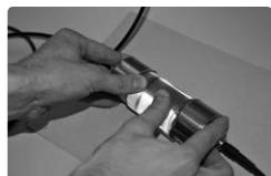
Acoplar los transductores a la varilla de calibración (F) usando el acoplador ultrasónico (E) y presionarlos firmemente contra ésta.
