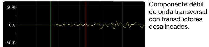
Rotar uno de los transductores alrededor de la posición de alineación y observar al aumento y la reducción del componente de onda transversal.
