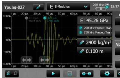
El modo de cursor dual es activado automáticamente. Usar el primer cursor para marcar el comienzo del componente de onda P. Usar el segundo cursor para marcar el comienzo del componente de onda transversal.
