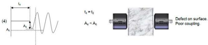
Defecto en la superficie. Acoplamiento deficiente.
